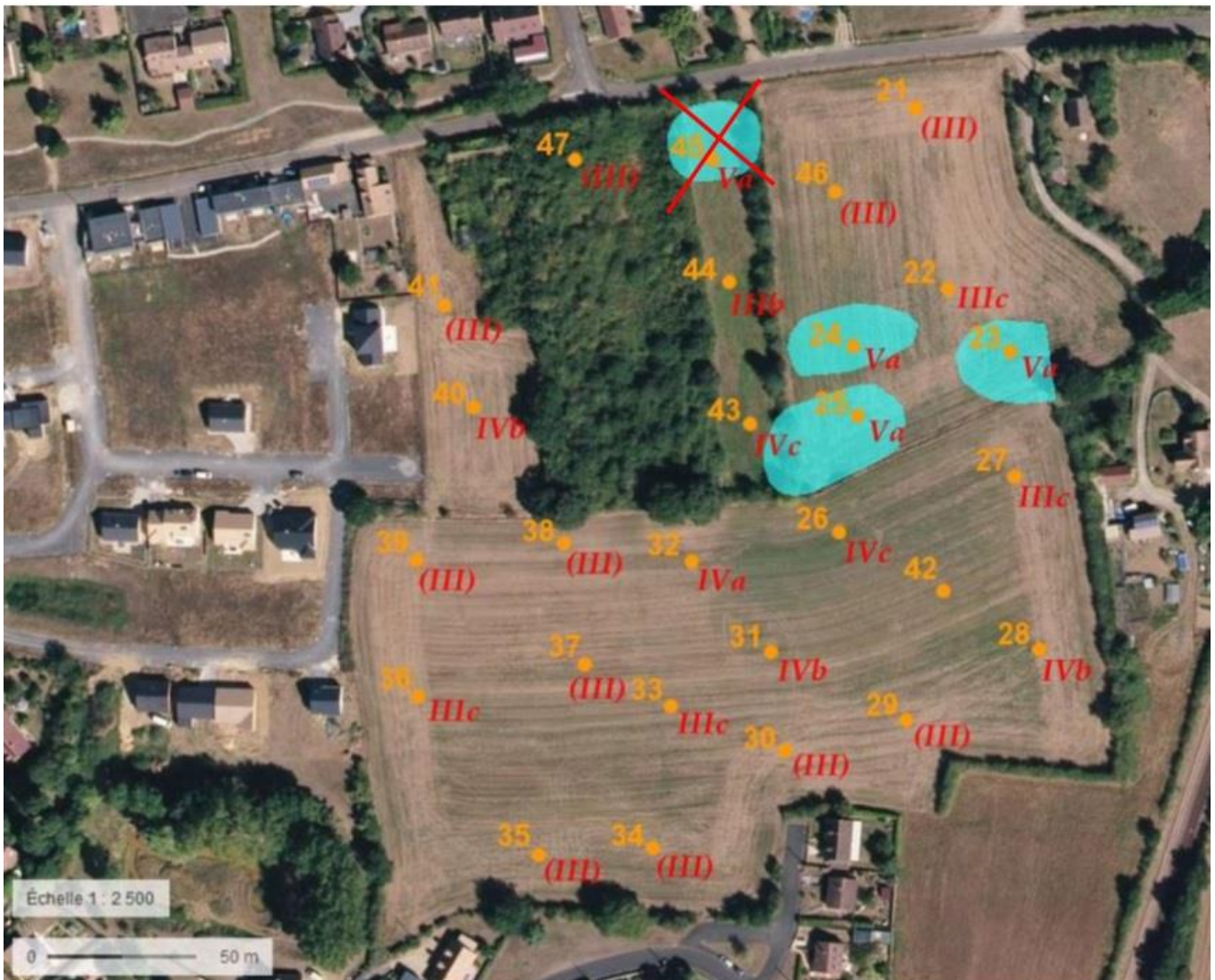
Repérage des zones humides dans la zone AUh Sud
